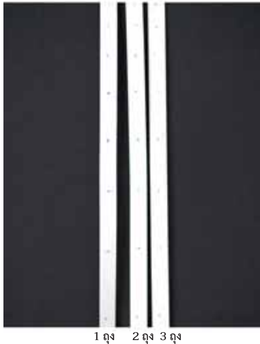
รูป 1.7 แถบกระดาษจากการติดถ่วงทราย 1 ถุง (ซ้าย) 2 ถุง (กลาง) และ 3 ถุง (ขวา)
