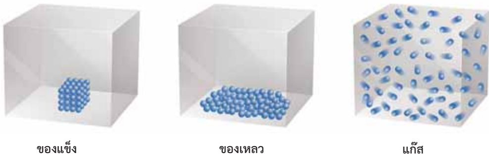
รูป 7.1 การจัดเรียงอนุภาคของสารชนิดหนึ่งที่อยู่ในสถานะของแข็ง ของเหลว และแก๊ส
